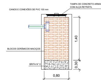
**DETALHE CAIXA DE INSPEÇÃO
