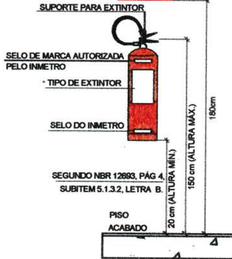
DETALHE DO EXTINTOR 01 SEM ESCALA
