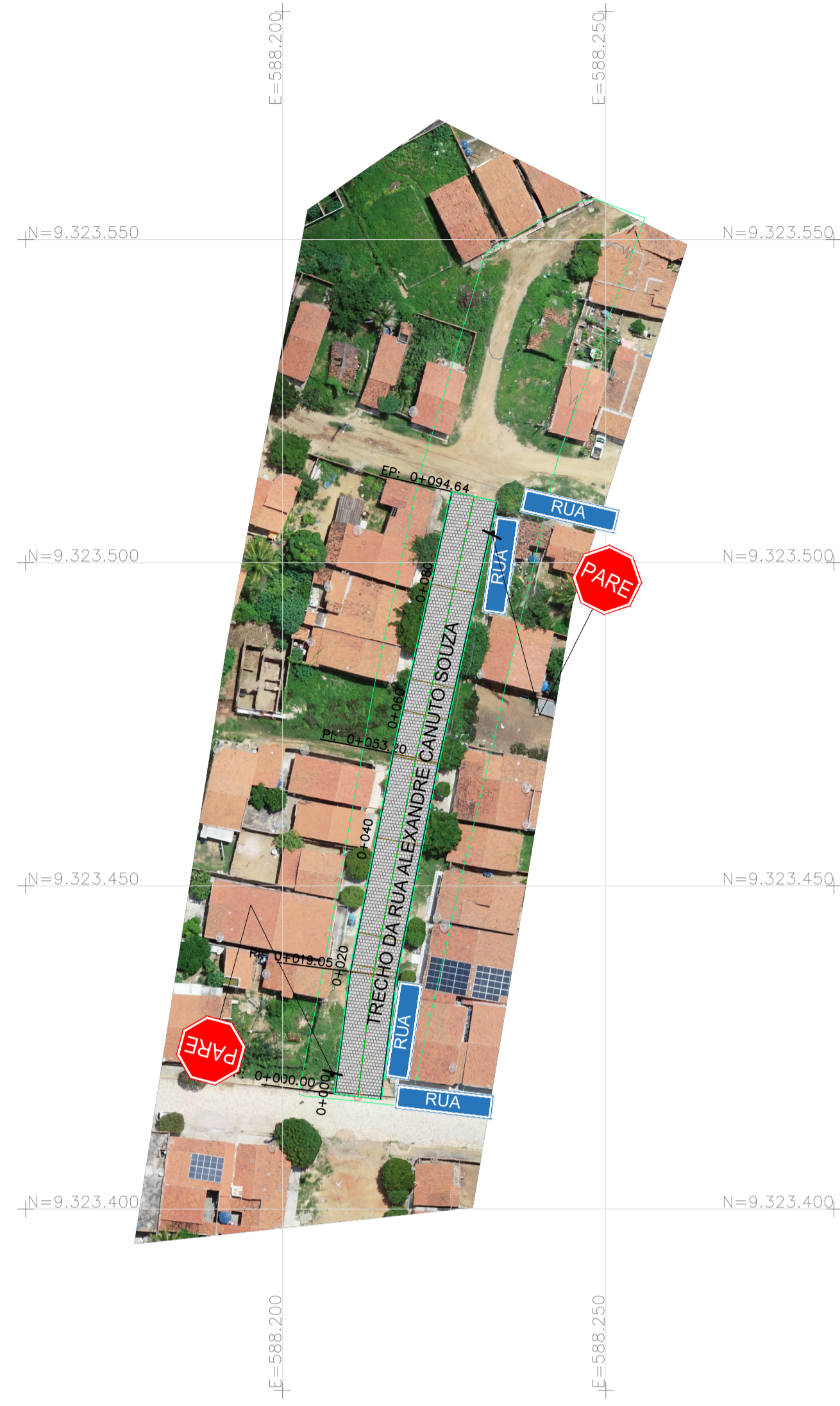
2 ALINHAMENTO HORIZONTAL, SINALIZAÇÃO HORIZONTAL E VERTICAL. ESCALA 1:750
